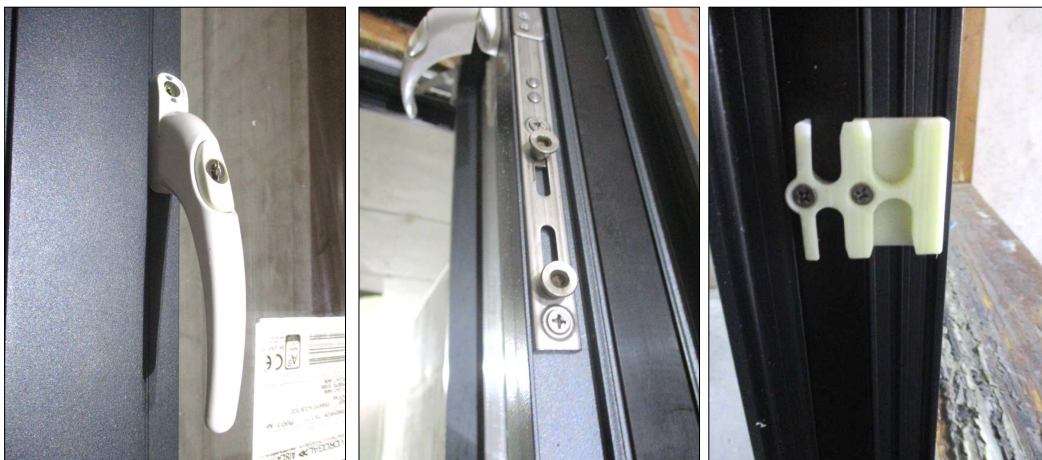
Imágenes 8 a 12 Detalles de la ventana ensayada (Herrajes)
