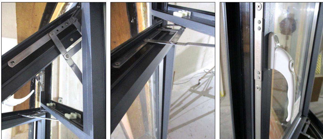
Imágenes 5 a 7 Detalles de la ventana ensayada (Herrajes)
