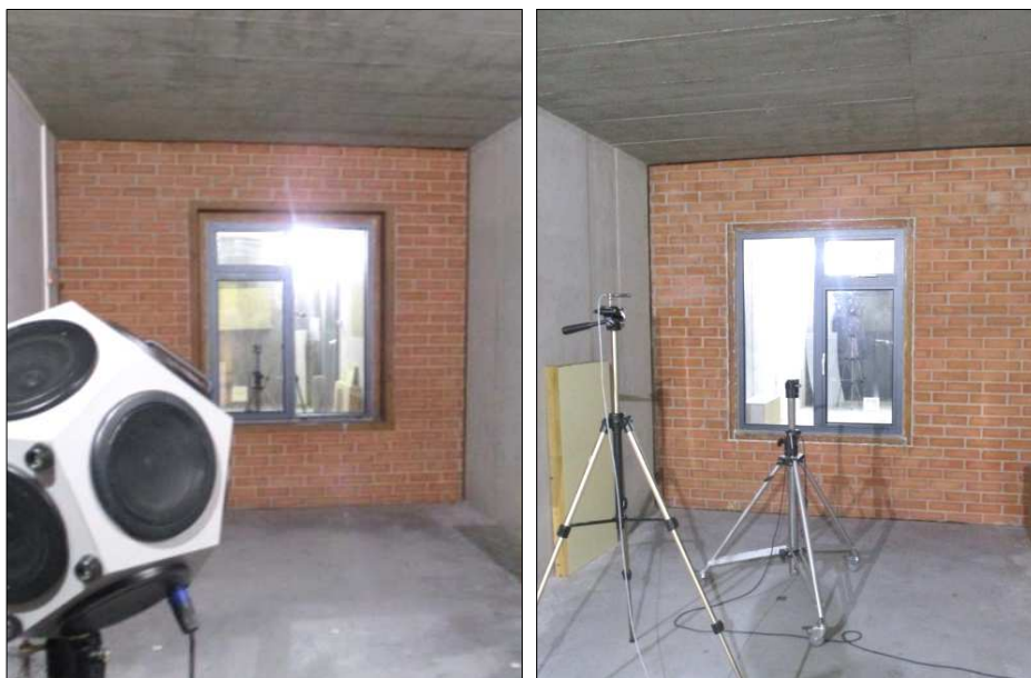
Imágenes 22 y 23 Ventana lista para ensayo; sala emisora y receptora respectivamente
