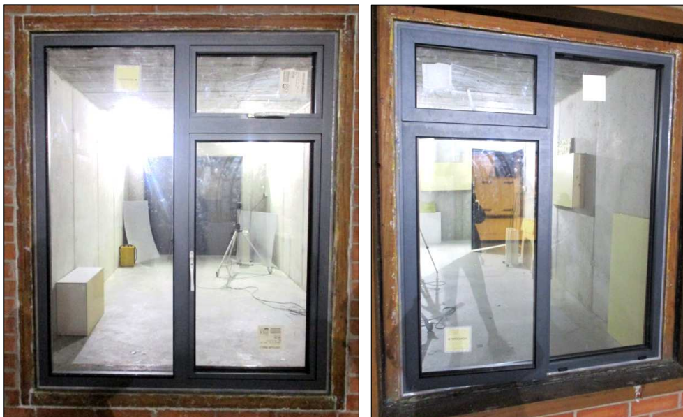
Imágenes 1 y 2 Ventana ensayada, cara interior (sala receptora) y exterior (sala emisora) respectivamente
